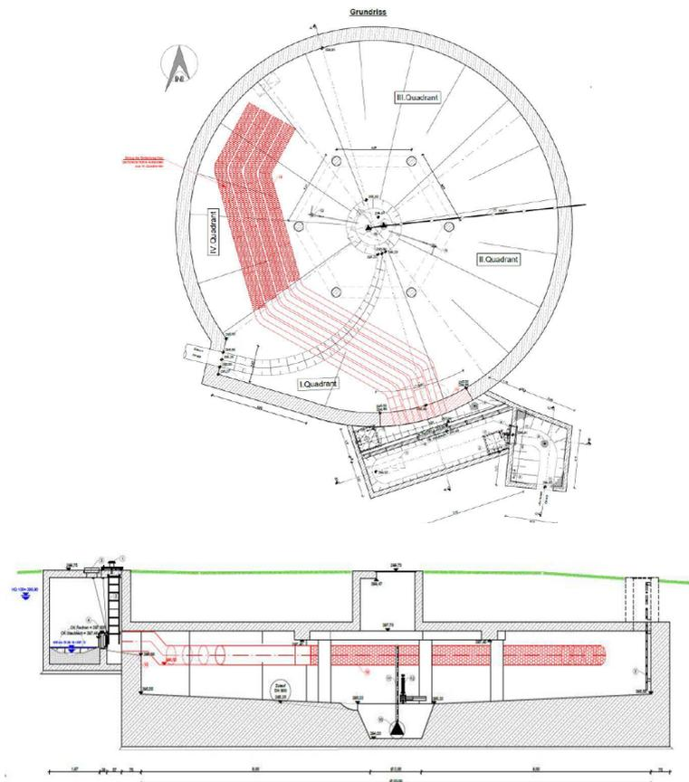
Für das Gewerbegebiet Wirtshöhe I und die Baugebiete Ackerlänge III und IV musste die Sohle der bestehenden Regenrückhaltebecken angepasst und die Auslaufbauwerke erneuert werden, um einen geregelten Abfluss zu gewährleisten.
