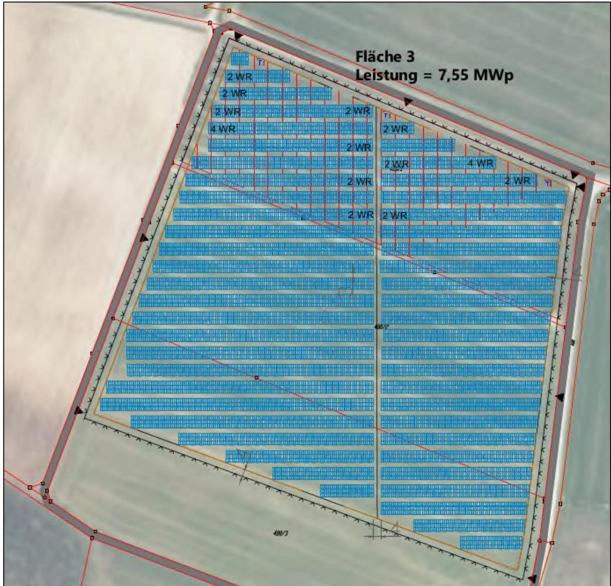
**Abbildung 4:** Anordnung und Anzahl der Wechselrichter (WR) und Trafostationen (T) auf der Fläche 3 [4]
