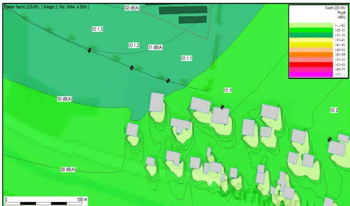
**Abbildung 5:** Pegelraster Nacht (5 m x 5 m, 4 m über Boden)
