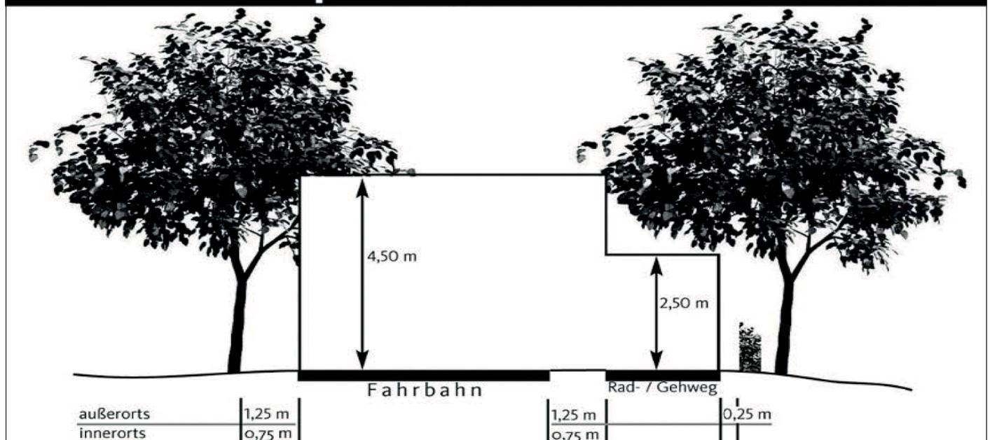
Als „Lichtraumprofil“ wird eine definierte Umgrenzungslinie bezeichnet, die meist für die senkrechte Querebene eines Fahrweges bestimmt wird.
